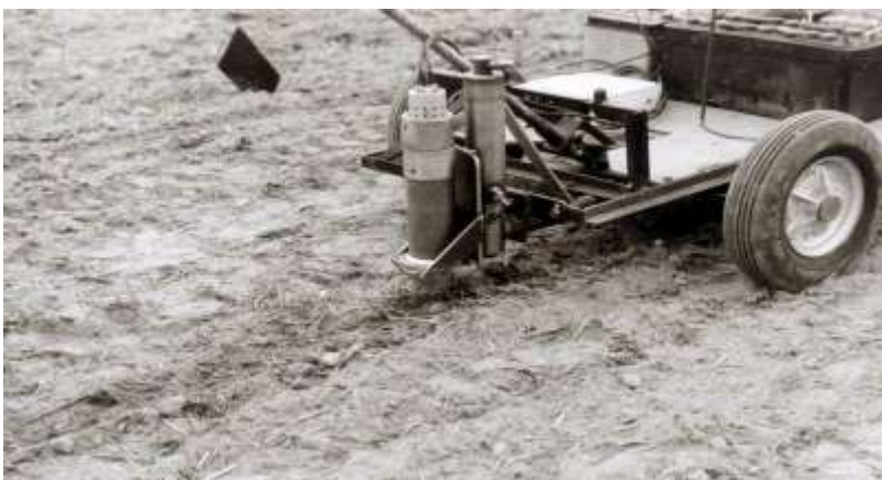
Rys. 5. Samojezdny skolimowany zestaw detekcyjny do badań terenowych
